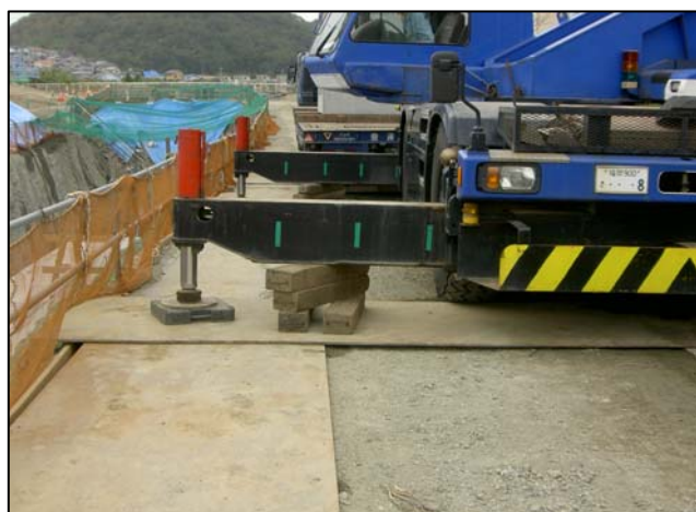
クレーンのアウトリガー設置状況
